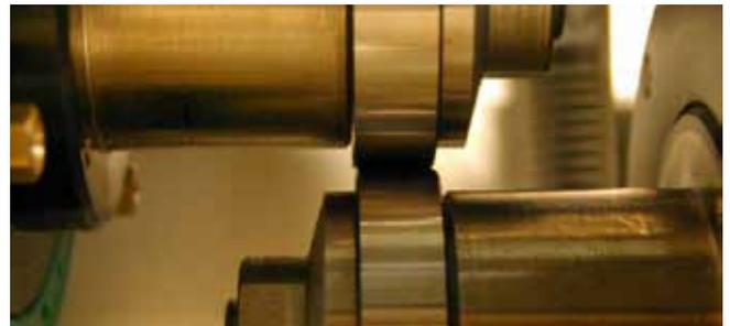
Abb. 1: Der Zwei-Scheiben-Prüfstand 2disc der Firma Optimol-Instruments, der bei den Tests verwendet wurde
